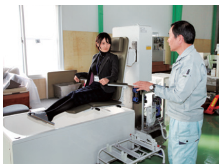
水の力のみで100キロまでスムーズに上下します。対話しながらの操作ができるよう全自動化したものを。介護者に安心感を与えることができます。
